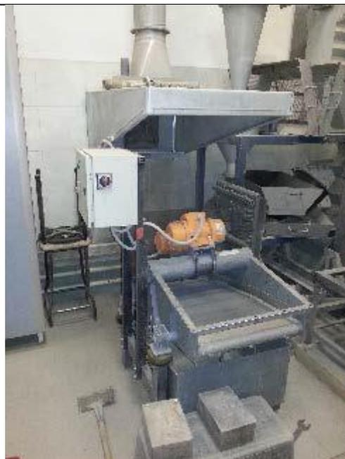
Рисунок 2.2 – Инерционный самобалансный вибрационный грохот ГИС-051
