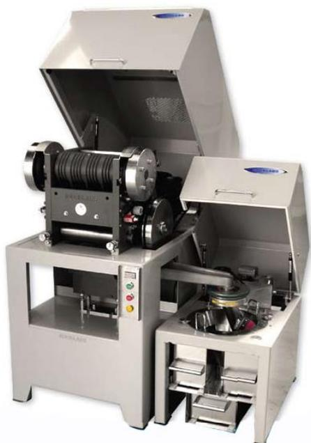
Рисунок 2.1 - Щековая дробилка «Boyd» с непрерывным сократителем Rocklabs
