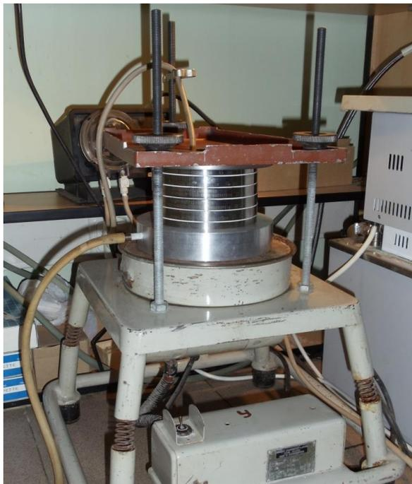
Рисунок 2.6 - Установка из микросит с вибрационным грохотом
