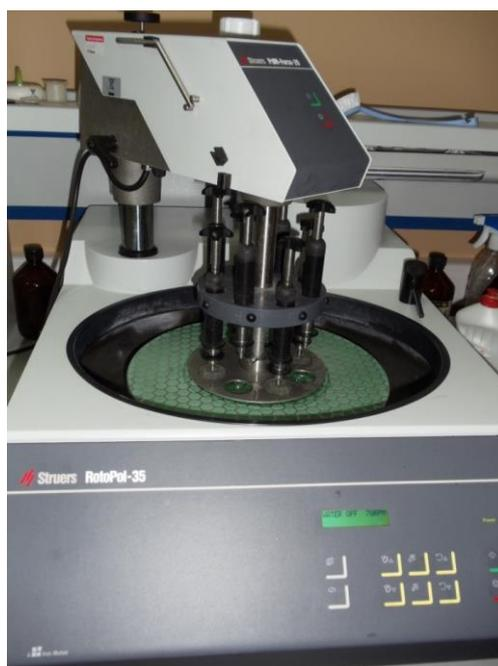
Рисунок 2.11 - Шлифовально-полировальный станок RotoPol-35
