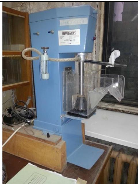
Рисунок 2.4 – Машина флотационная лабораторная 240ФЛ (камера 3 л)
