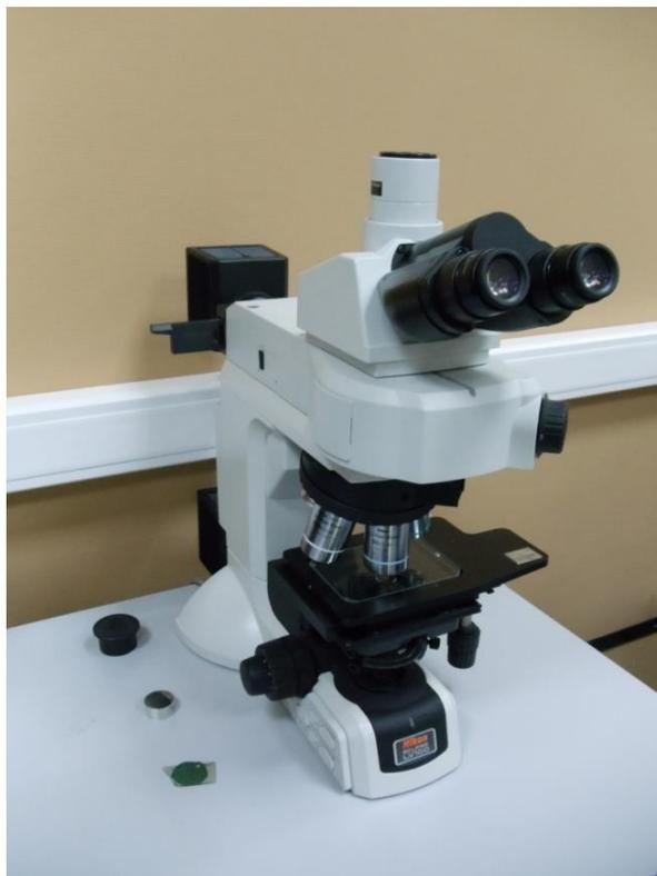
Рисунок 2.12 – Оптический микроскоп Nikon Eclipse LV 100
