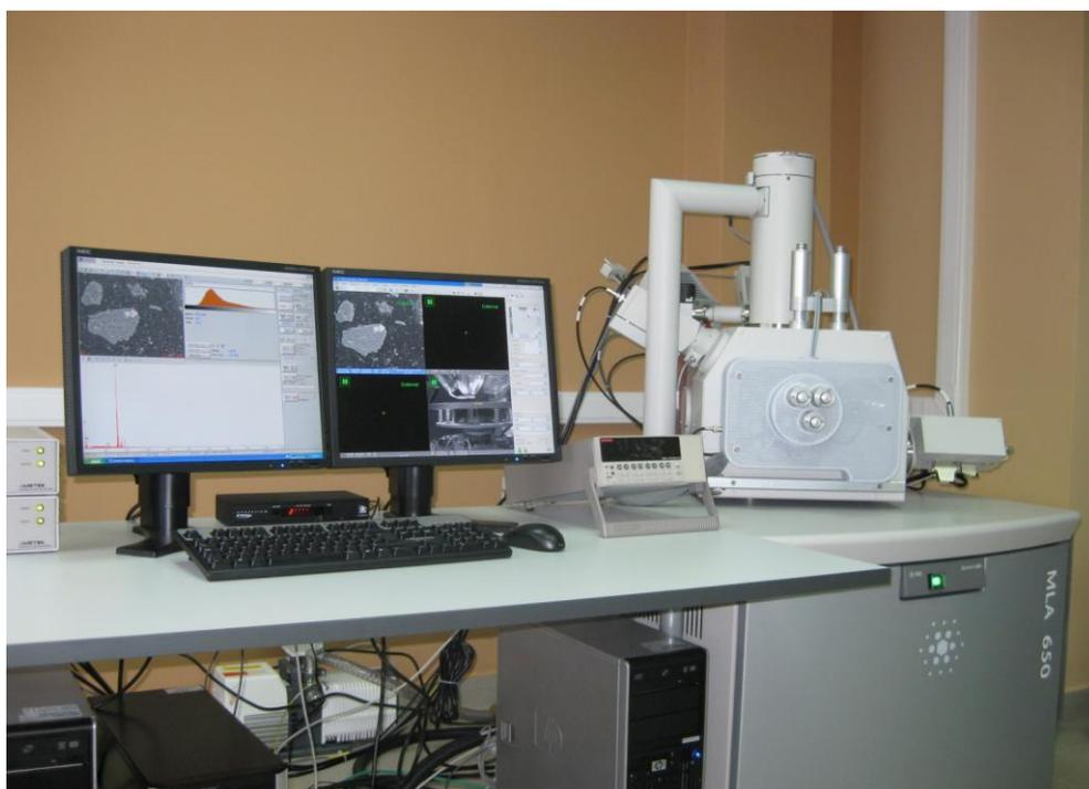
Рисунок 2.14 – Автоматизированный минералогический комплекс MLA System
