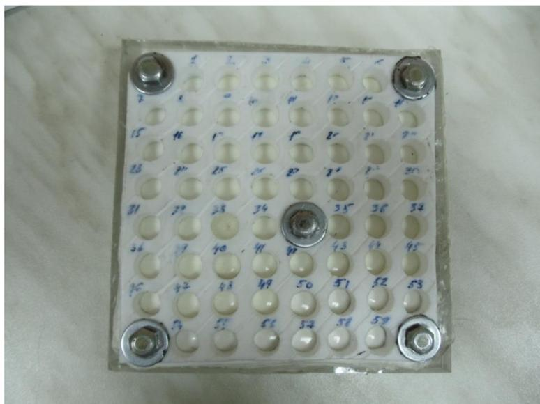
Рисунок 2.8 - Форма для заливки образцов
