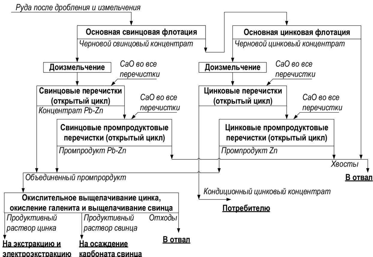
Рисунок 5.6 – Предлагаемая комбинированная технология переработки упорной свинцово-цинковой руды с высоким содержанием флотативного пирита
