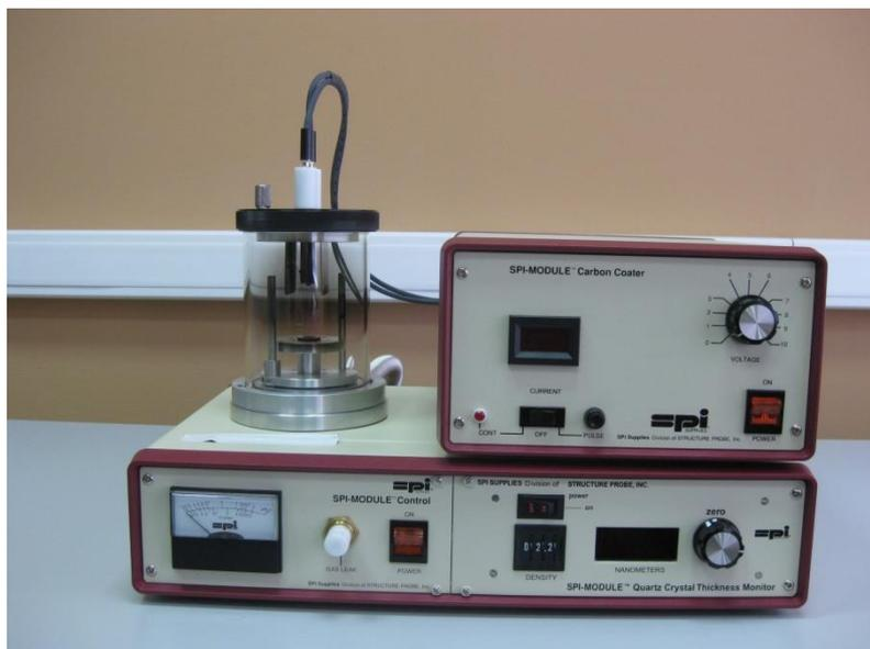
Рисунок 2.13 - Система для напыления углеродного слоя SPI-Module
